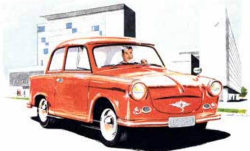
MIT ZWEITAKT-ZWEIZYLINDERMOTOR UND EINLASSDREHSCHIEBER
